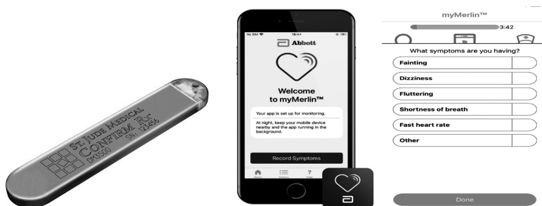
Рисунок 2. Имплантируемый кардиомонитор Confirm Rx и приложение MyMerlin в личном мобильном устройстве пациента
